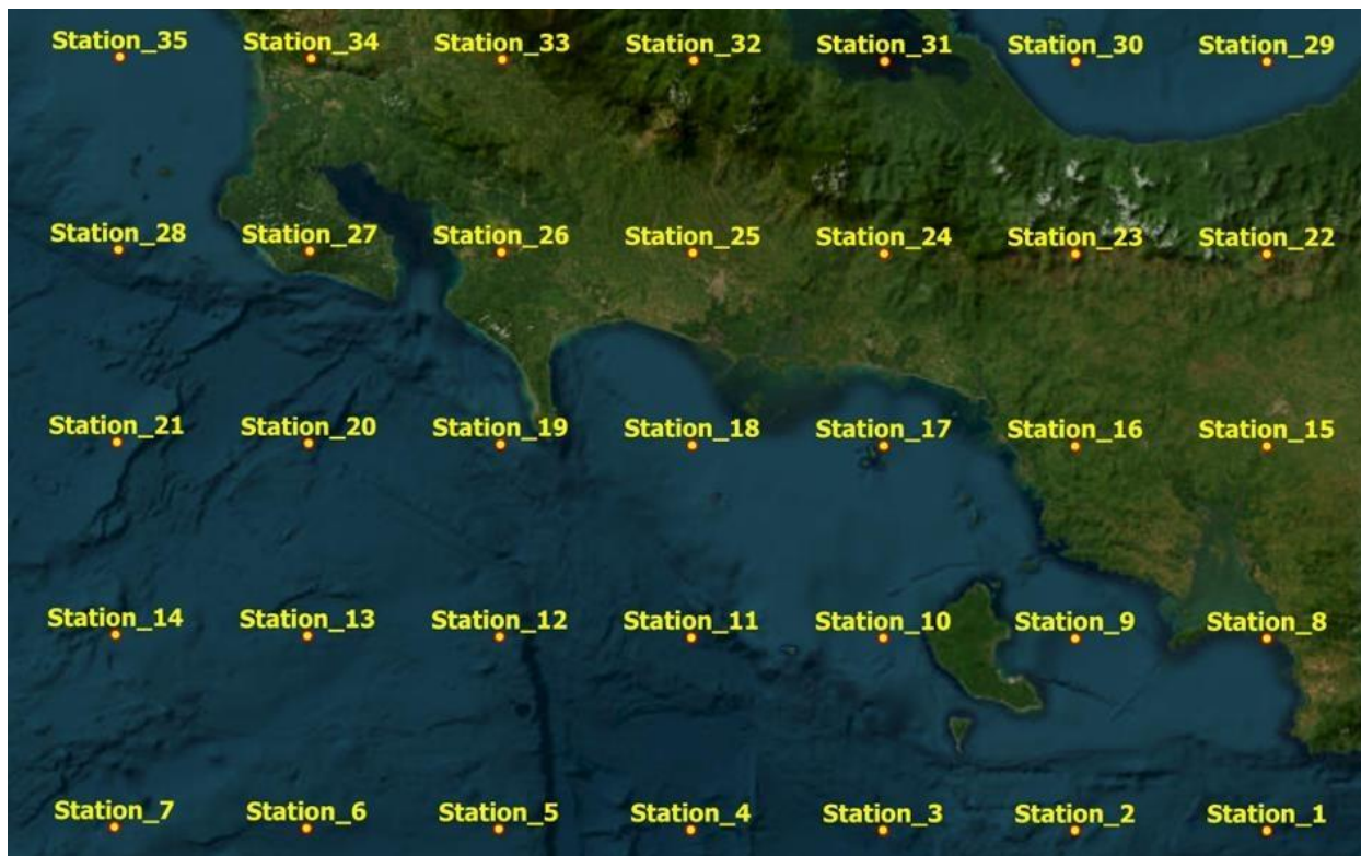
Figura 4-2: Estaciones del reanálisis ERA5 para parámetros de viento y oleaje frente a la costa de Puerto Armuelles. La numeración de las estaciones es arbitraria.
